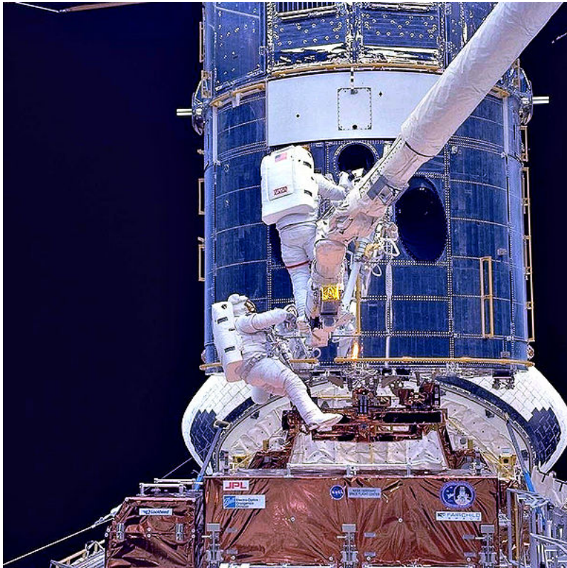
Astronotlar 1993'te uzay mekiği ile yaklaştıkları Hubble teleskobunun aynasına parça takıyor
