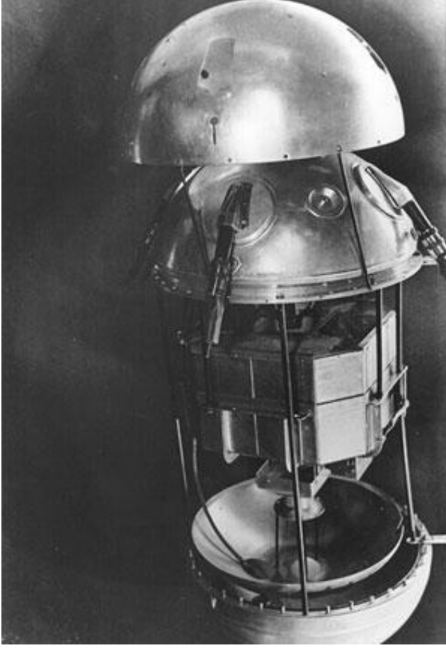
Sputnik'in iç yapısı (alüminyum alaşım koruyucu en dışta)
