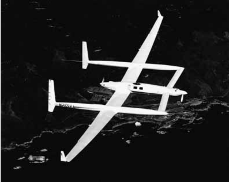
Durmadan ve yakıt almadan dünya etafında tur atan fiber takviyeli plastik uçak (1986)
